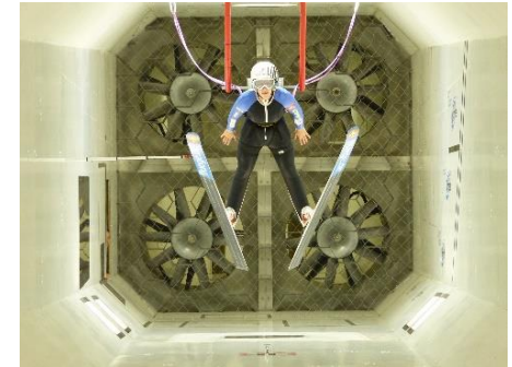
Fig.1: Banc d'essai en soufflerie pour le saut à ski
