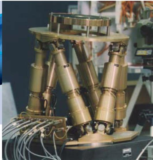
Fig. 2 - Test d'un hexapode (Hexapod Pointing System) développé par la NASA pour la station spatiale internationale (ISS), qui comprend 6 vis à rouleaux
